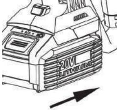
Para separarla de la máquina pulse el botón de anclaje de la batería y deslice en la dirección que indica la imagen.
