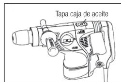
**2.** Coloque 30g de grasa (el contenido de un tubo) en la caja de engranajes.
